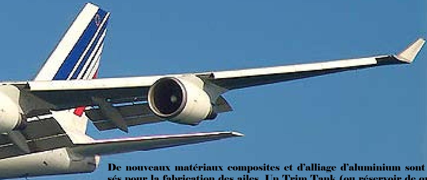
**De nouveaux matériaux composites et d'alliage d'aluminium sont utilisés pour la fabrication des ailes. Un Trim Tank (ou réservoir de queue) est également rajouté. Le Boeing 747-400 possède des moteurs plus économiques et performant permettant un grand rayon d'action impressionnant de 14205 Km (7670 Nm) avec un MTOW allant jusqu'à 396895 Kg (875000 Lb) et une configuration classique de 420 passagers réparti en trois classes. Sa vitesse maximale est de 939 Km/h (507 kt).**
